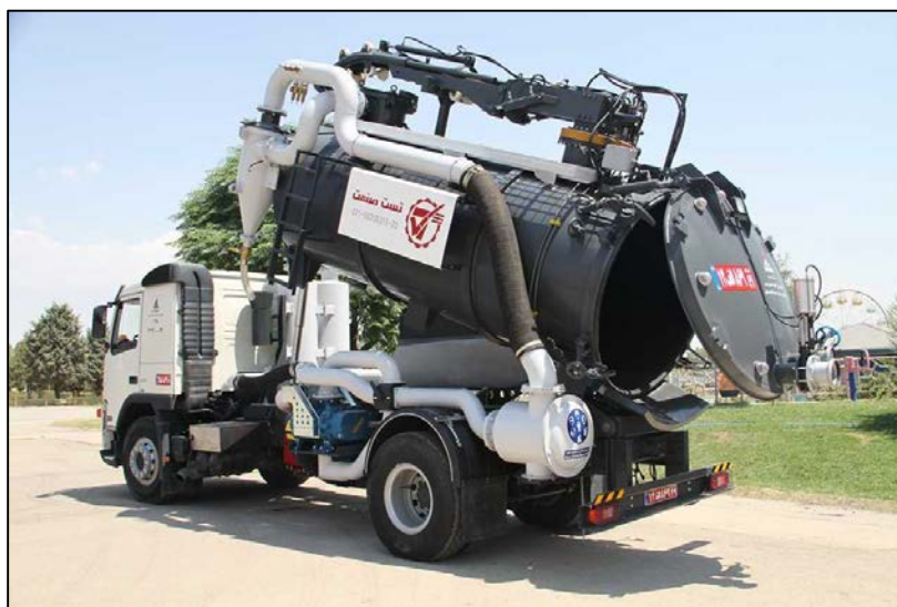
شکل ۶۰: نمونه از ماشین‌های شستشوی مجاری زهکشی
