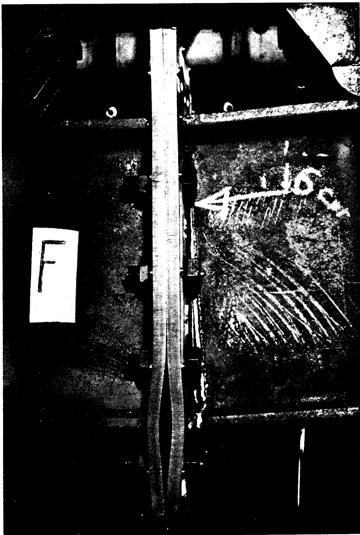
تصویری از آزمایش اتصال فلنجی.
